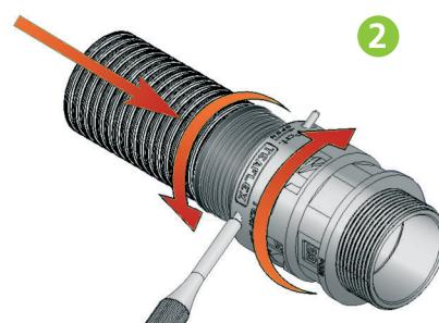
Przekręcić blokadę do pozycji otwartej, wciśnąć rurę z zamontowaną uszczelką do złączki. Upewnić się, że rura jest wciśnięta do końca złączki.
