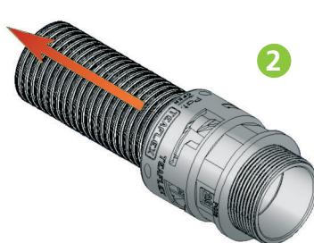
Lekko pociągnąć rurę w celu upewnienia się, że system JAW-FIT jest prawidłowo osadzony.
