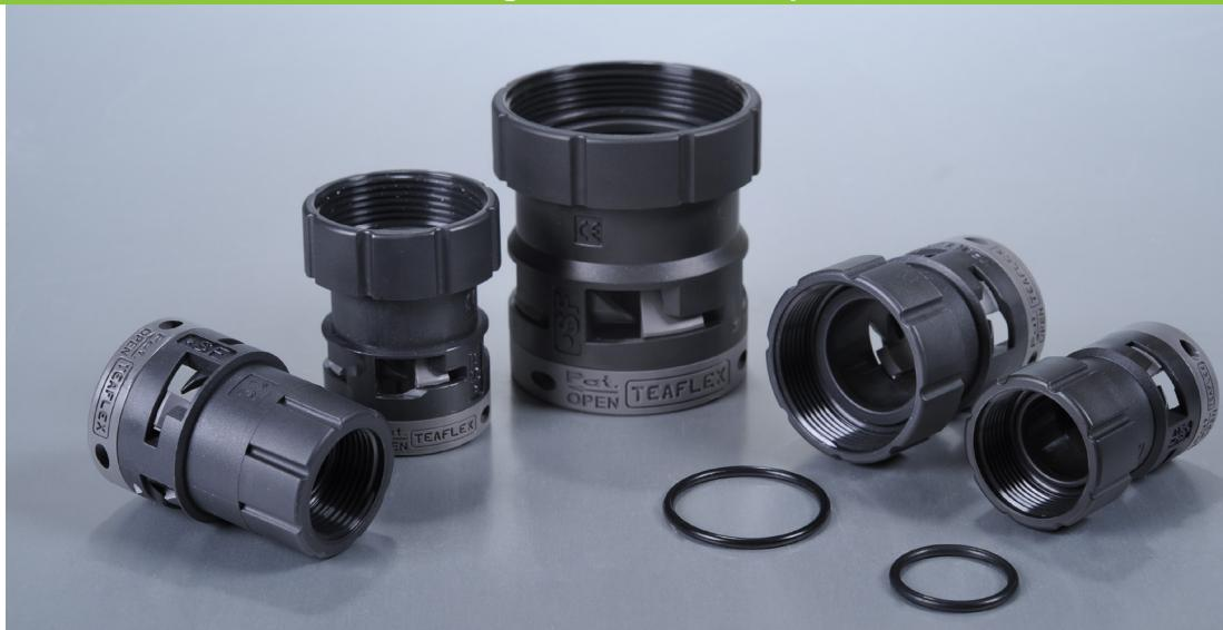
Złączki typu SF z gwintem żeńskim UNEF z tworzywa zaprojektowano dla połączenia z wtyczkami z serii MIL-DTL-5015. Spełniają standardowe wymogi przemysłowych instalacji elektrycznych jak również podwyższone wymagania przemysłu ciężkiego i kolejowego. Złączki dostarczane są wraz z uszczelką.
